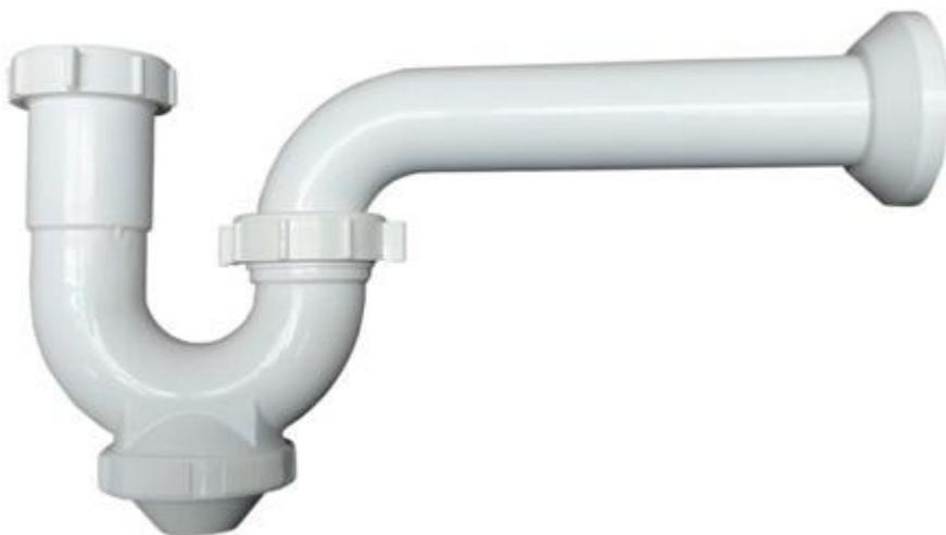
La función de las trampas es formar una cantidad suficiente de agua "estancada" provisional que hace la función de tapón del interior hacia afuera del olor acumulado en la tubería.
